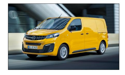
Combo BEV: do 280 km (baterija 50 kWh) Vivaro / Zafira BEV: do 230 km (baterija 50 kWh) do 330 km (baterija 75 kWh)
